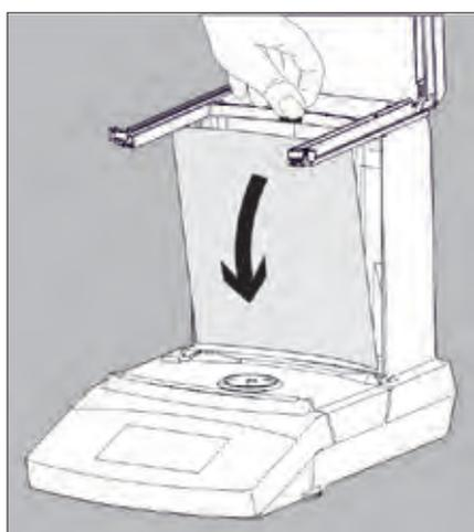
必要に応じて、清掃のために風防内背面パネルを取り外します。
